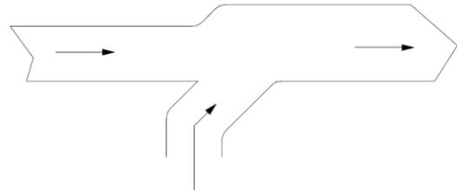
Es ist nicht möglich, einen Sammeln Rohr für mehr Gas beheizte Maschinen zu installieren. Für elektrisch oder Dampf beheizte Maschinen ist es möglich einen Sammeln Rohr vorzusehen. Vorbereiten Sie „T“ Verbindungen nicht und schätzen Sie den Sammeln Rohr Durchmesser gut.
