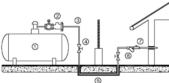
Hoher Druck Tank Flasche Abwärts (1), verbinden Sie einen erste Stufe Regler (1,5bar) u. korrekt dimensionierte Ventil (2).
