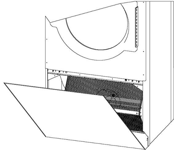
Um den Filter zu reinigen, öffnen Sie die kleine Tür oder (in besonderen Modelle) die Schublade ziehen, um den Filter zu erreichen.
